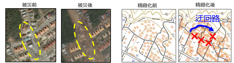
空中写真の比較による被災状況把握
